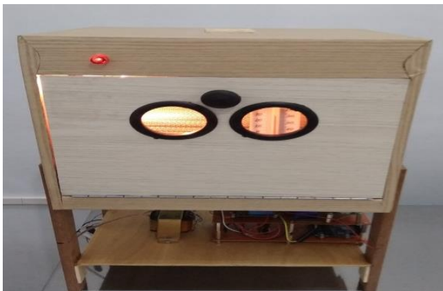
Gambar 5. Sistem Perancangan Alat Pentetas Telur Otomatis Sensor Suhu DHT – 11 Berbasis Mikrokontroler ATmega 328p
