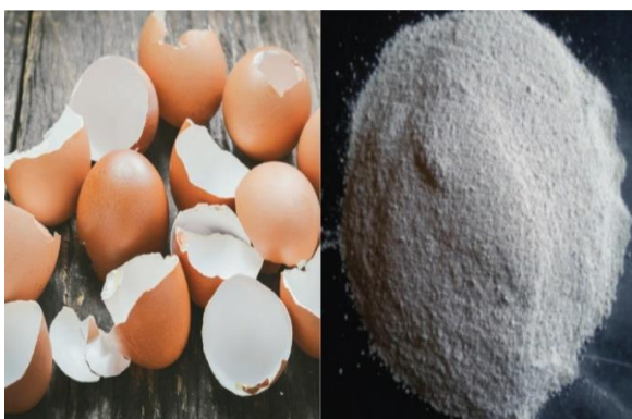
Gambar 1. Cangkang Telur (a) dan Serbuk Cangkang Telur/ Eggshell Powder (b) untuk Bahan Stabilisasi Tanah
