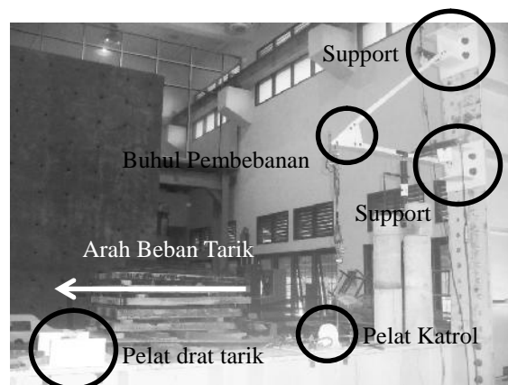
Gambar 3 . Mekanisme Pengujian Batang Tekan Pada Rangka Batang
