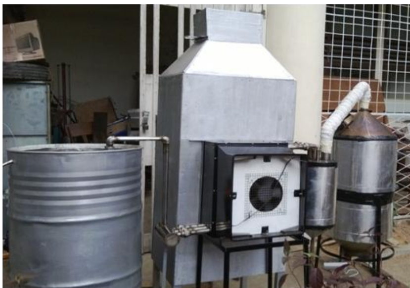
Gambar 7. Unit penghasil asap cair yang terintegrasi dengan pengering kabinet (hasil pabrikasi)
